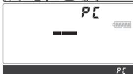
Wenn Nikon Capture 4 Camera Control ausgeführt wird, wird auf dem Display **PC** anstelle der Anzahl verbleibender Aufnahmen angezeigt. Aufgenommene Bilder werden direkt auf der Festplatte des Computers gespeichert und nicht auf der Speicherkarte der Kamera. Weitere Informationen finden Sie im *Referenzhandbuch zu Nikon Capture 4*.
