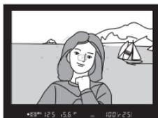
Bei aktiviertem Belichtungs-Messwertspeicher wird die Anzeige **AE-L** im Sucher eingeblendet.
