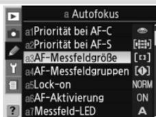
So können Sie mit der FUNC-Taste und dem vorderen Einstellrad die Größe des Fokusmessfelds auswählen:
