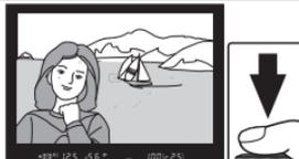
Beim Einzelaufokus bleibt der Fokussmesswert zwischen den Aufnahmen gespeichert, solange der Auslöser bis zum ersten Druckpunkt gedrückt gehalten wird. Dadurch können hintereinander mehrere Bilder mit derselben Fokuseinstellung aufgenommen werden. Der Fokussmesswert bleibt ebenfalls zwischen den Aufnahmen gespeichert, wenn die **AE-L/AF-L**-Taste gedrückt wird.
