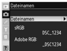
**Zeichenauswahl:** Markieren Sie mit Hilfe des Multifunktionswählers einen Buchstaben und drücken Sie den Multifunktionswähler anschließend in der Mitte, um den Buchstaben auszuwählen.
