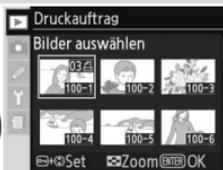
Drücken Sie die Taste **OK** und anschließend den Multifunktionswähler oben oder unten, um die Anzahl der Exemplare (bis zu 99) festzulegen, oder drücken Sie die mittlere Taste des Multifunktionswählers, um das Bild auszuwählen und die Anzahl der Abzüge auf »1« einzustellen. Markierte Fotos sind durch ein kenntlich gemacht.
