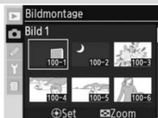
**4** Drücken Sie die mittlere Taste des Multifunktionswählers, um das markierte Bild auszuwählen und zur vorherigen Ansicht zurückzukehren. Das ausgewählte Bild wird als »Bild 1« angezeigt.
