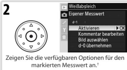
\* Um den Weißabgleich auf den markierten eigenen Messwert zu setzen und in die Aufnahmebetriebsart zurückzukehren, ohne Schritt 2 durchzuführen, drücken Sie die Taste **OK**.
