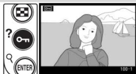
Sie können den Schutz jederzeit wieder aufheben, damit das Bild gelöscht werden kann. Um die Kennzeichnung wieder zu entfernen, zeigen Sie das Bild in der Einzelbilddarstellung an oder markieren es im Bildindex und drücken anschließend die Taste **Ctrl**.
