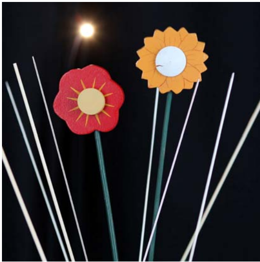
Testmotiv: zwei auch unter Scheinwerferlicht nicht verwelkende Blumen, Holzstäbchen und Metallstricknadeln als Modell für Grashalme und im Hintergrund eine kleine, helle, kreisrunde Lichtquelle als Blendenindikator.
