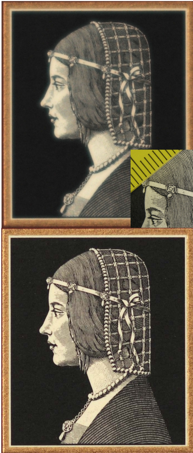
Ein ca. 700x820 Pixel großer Ausschnitt aus einem 24MP-Bild, oben mit starker sphärischer Aberration, unten gut korrigiert. Die Schraffur im Haar liegt im Sensorbild bei etwa 40 Lp/mm. Aufnahme im Maßstab 1:10. Diese Bilder liegen zum Download auf unserem Server.
