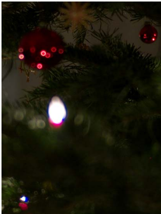
Vordergrund-Unschärfe mit ringförmigen Strukturen beim Sonnar 1.5/50 ZM, einem sphärisch unterkorrigierten Objektiv
