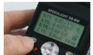
Von hier aus steuern Sie alles. Stellen Sie am LCD-Monitor des Master-Blitzgeräts SB-800 die Blitzbetriebsart ein, schalten Sie Blitzgerätegruppen ein oder aus und korrigieren Sie die Blitzleistung für bis zu vier Blitzgerätegruppen.
